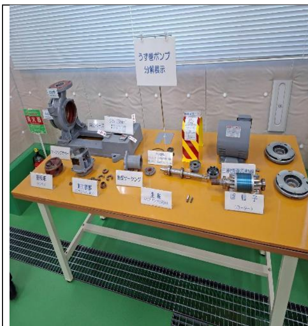
圖 2.23 抽水機設備內部構造解析
