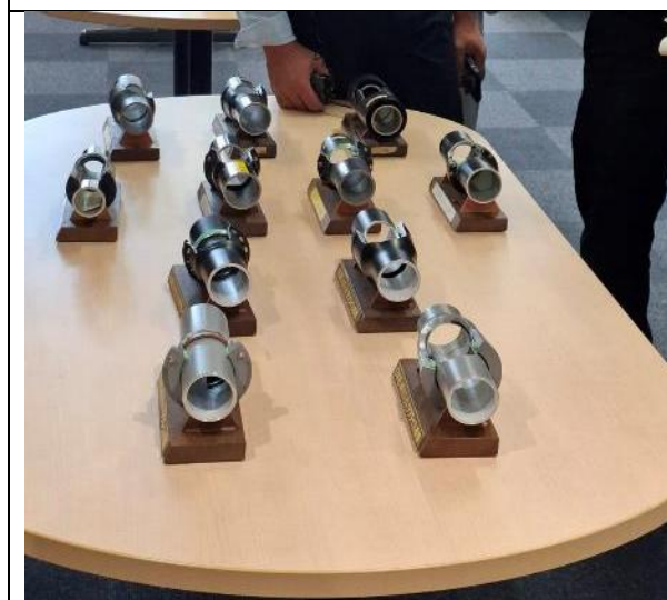
圖 2.45 各鑄鐵管接頭斷面模型展示
