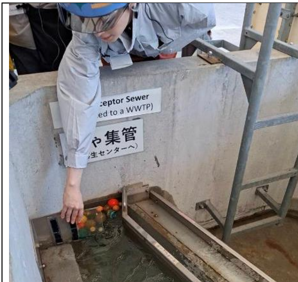
圖 2.13 加裝制御板後可產生漩渦
