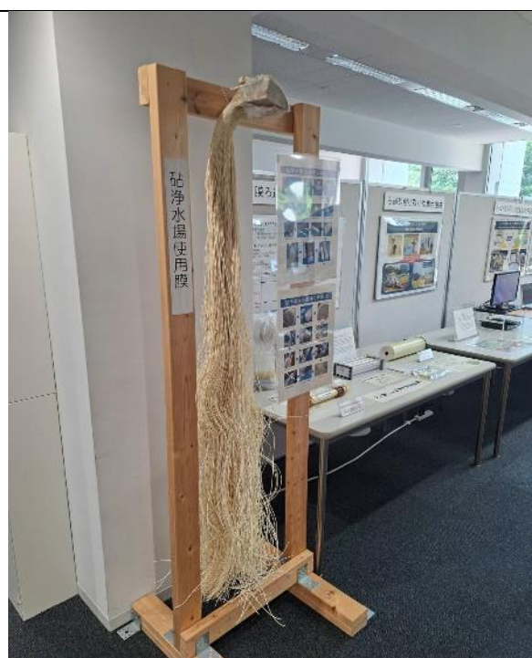
圖 2.54 淨水場膜過濾組件實物展示
