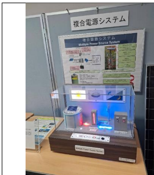
圖 2.55 水務設施複合電源系統模組
