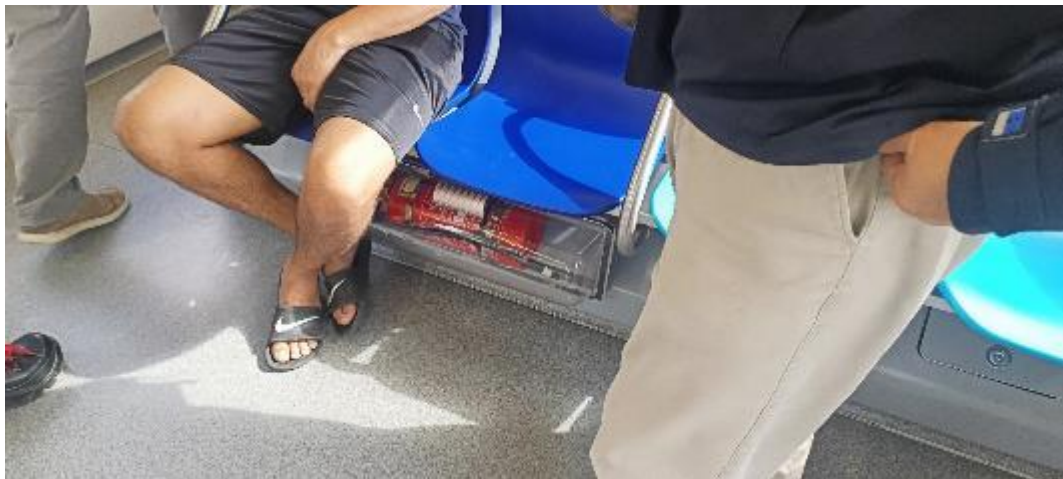
圖 94 聖保羅捷運 15 號線單軌列車滅火器配置
