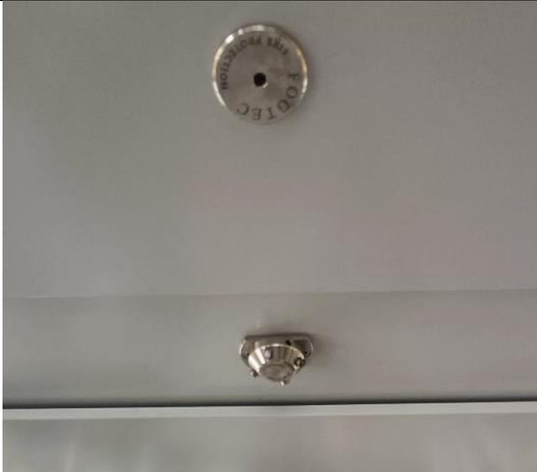
圖 93 聖保羅捷運 15 號線單軌列車配置撒水系統
