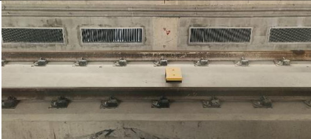
圖 111 聖保羅 6 號線列車定位應答器
