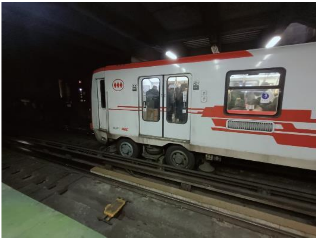
圖 56 智利聖地牙哥捷運 5 號線列車採膠輪系統
