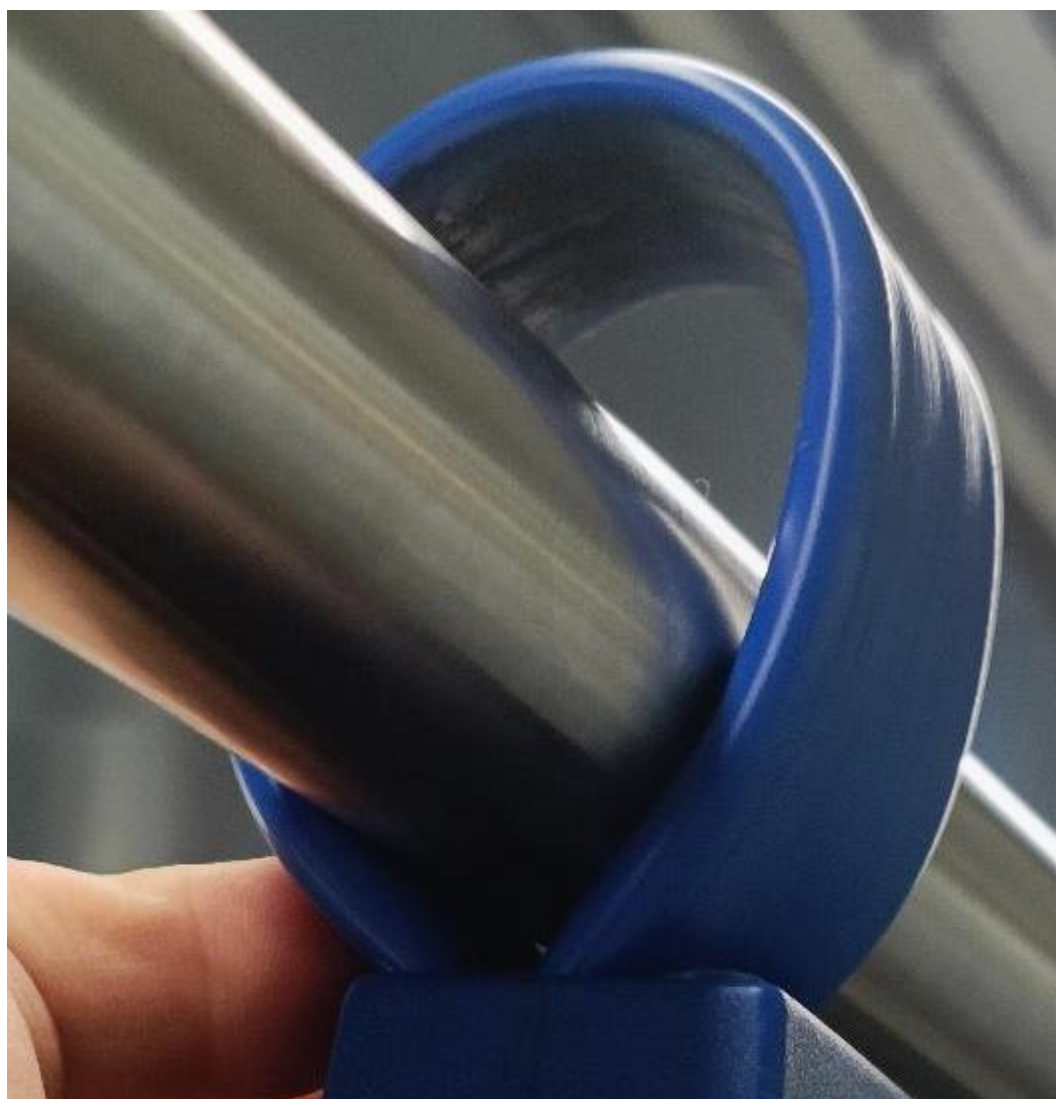
圖 69 輕軌列車扶手拉環未限定固定位置
