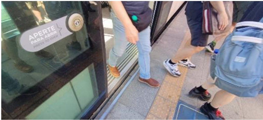
圖 75 輕軌列車與月台間隙
