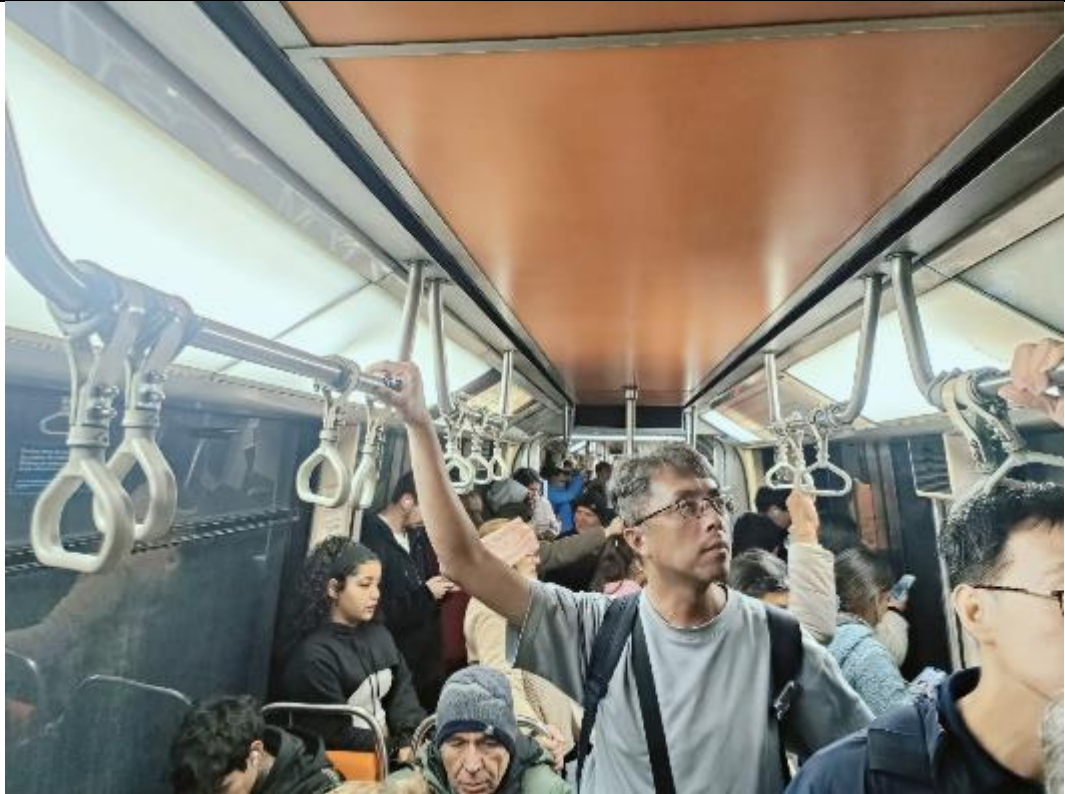
圖 57 智利聖地牙哥捷運 5 號線列車扶手設計
