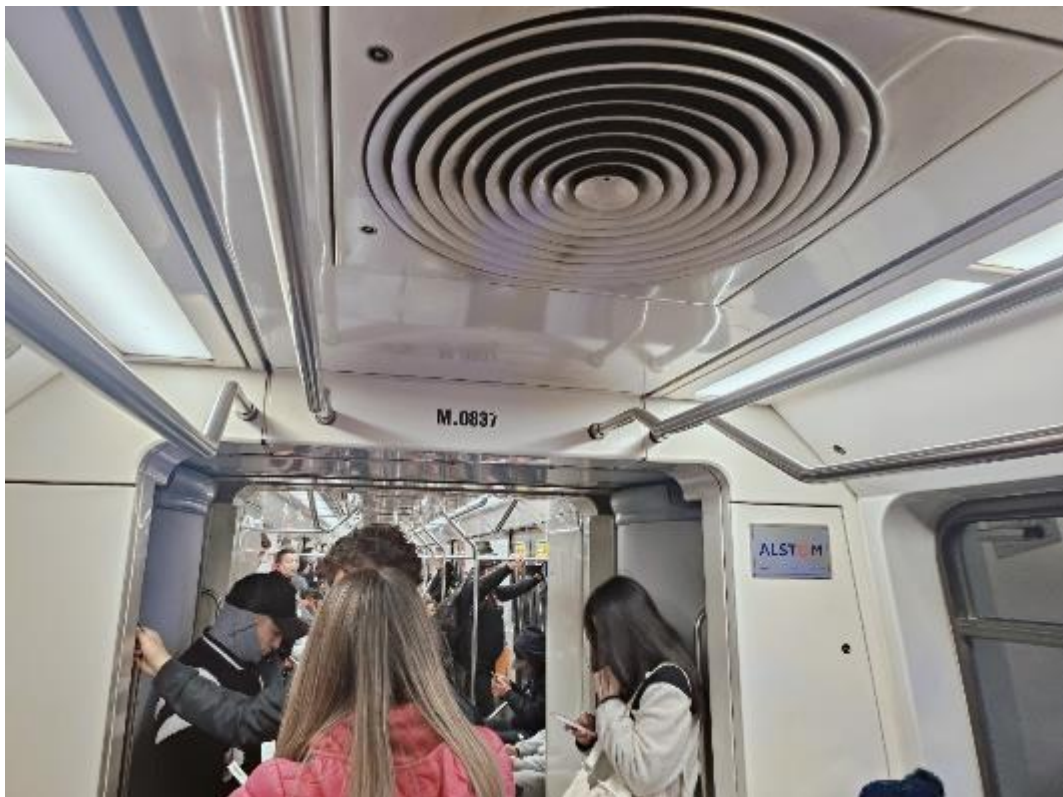
圖 49 智利聖地牙哥捷運 4 號線列車空調系統
