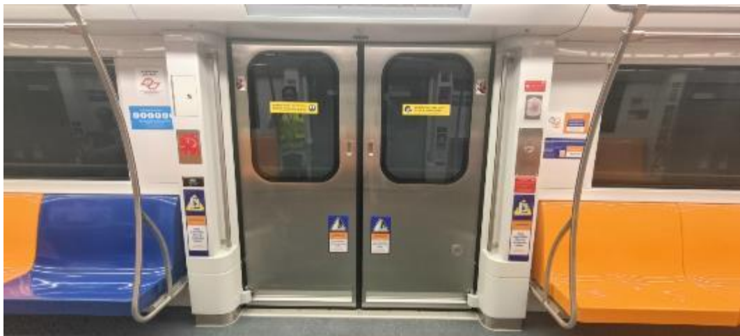
圖 115 聖保羅 6 號線列車車門配置、車門釋放裝置、緊急對講機
