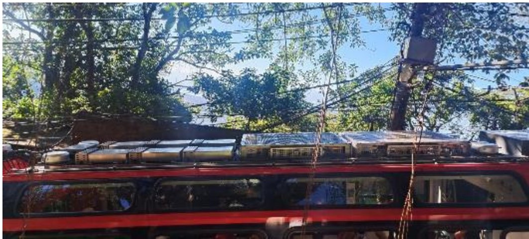
圖 150 柯科瓦多列車車頂設備配置
