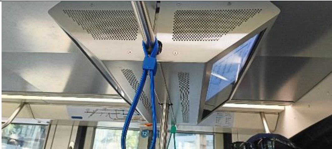
圖 70 輕軌列車扶手系統整合多媒體顯示器空間
