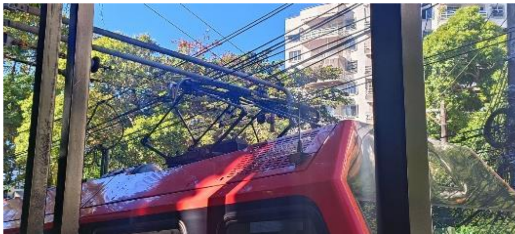
圖 145 柯科瓦多列車雙臂式集電弓
