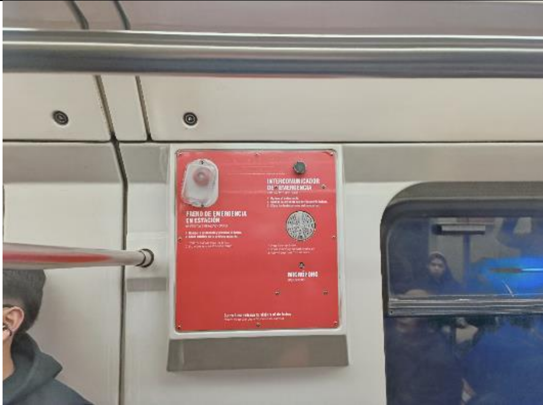
圖 48 智利聖地牙哥捷運 4 號線列車緊急對講機設備
