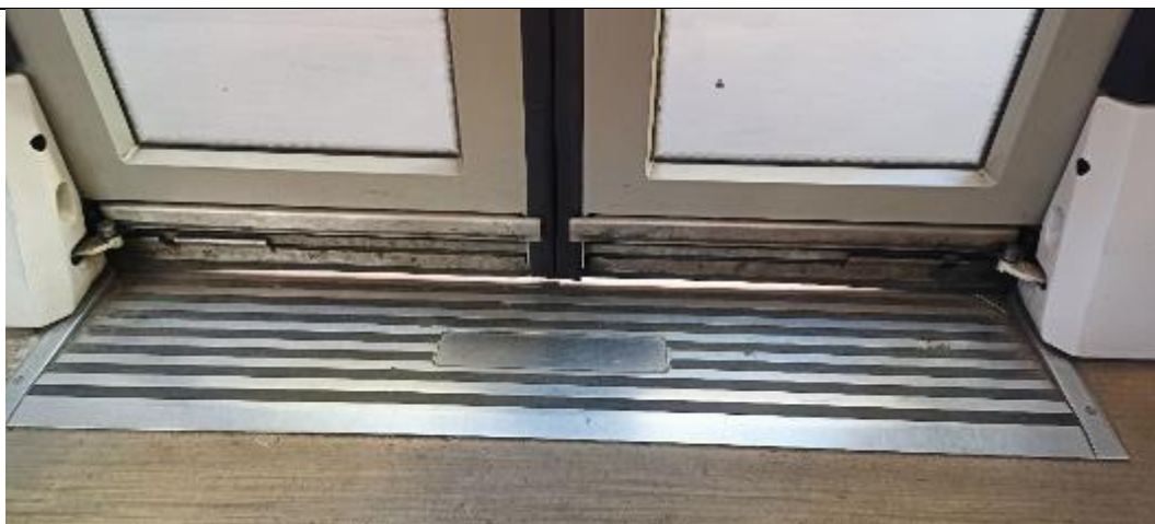
圖 68 輕軌列車進出口止滑設計
