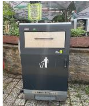
圖 2.4.28 採用太陽能為動力的壓縮垃圾桶
