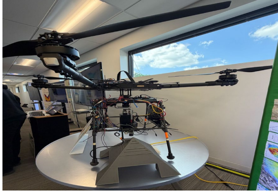
圖 13(115/4/24)：了解 Richardson City 正研發透過無人機偵測空氣中有毒物質，達成空氣品質監控，維護市民健康
