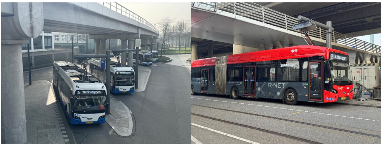
圖2.4.5 Amsterdam Sloterdijk 地鐵外公車使用集電弓充電
