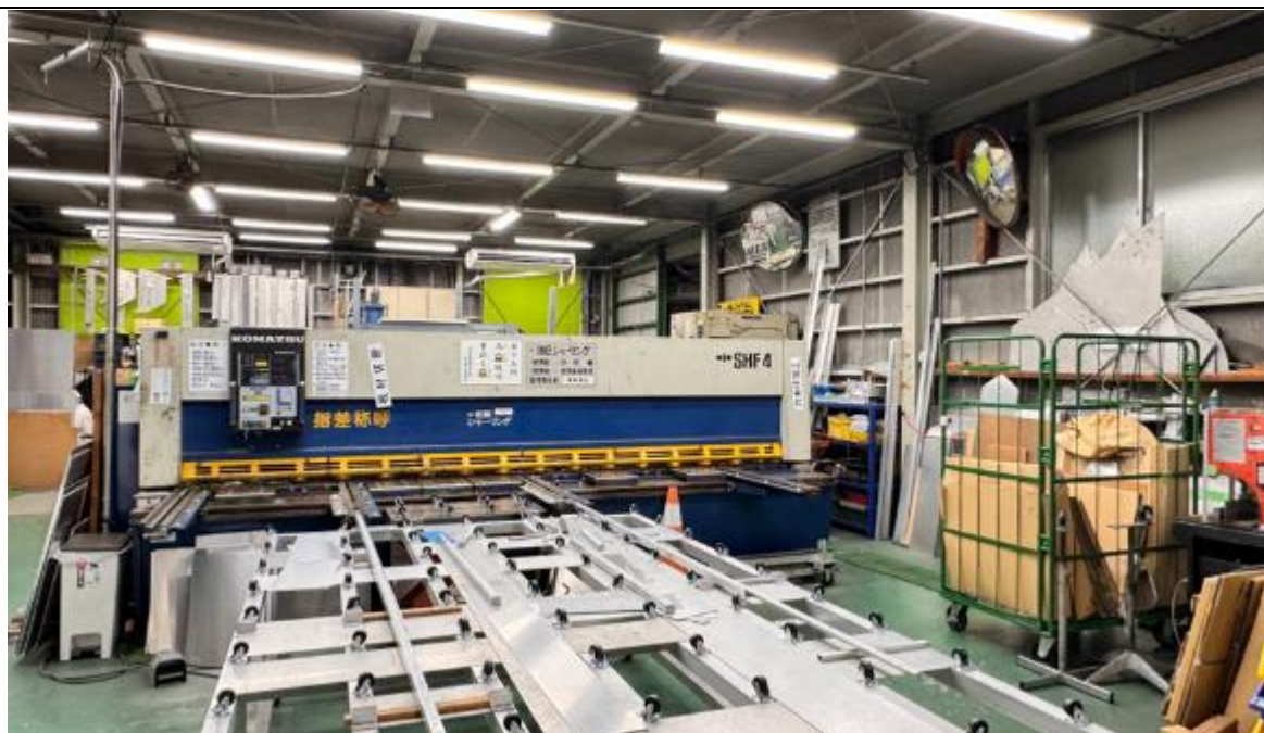
圖2.4.4 標誌板材剪切加工設備
