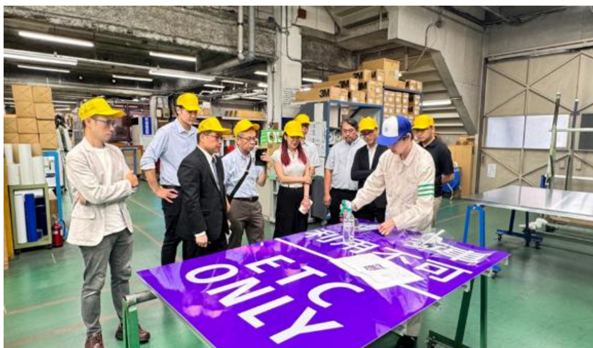
圖2.4.5 大型標誌反光膜與文字圖樣製作示範
